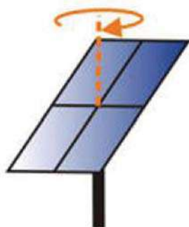
a. Cu axă unică azimutală (orientare variabilă) Colectorul se orientează în raport cu poziția aparentă a soarelui, pe axa verticală
